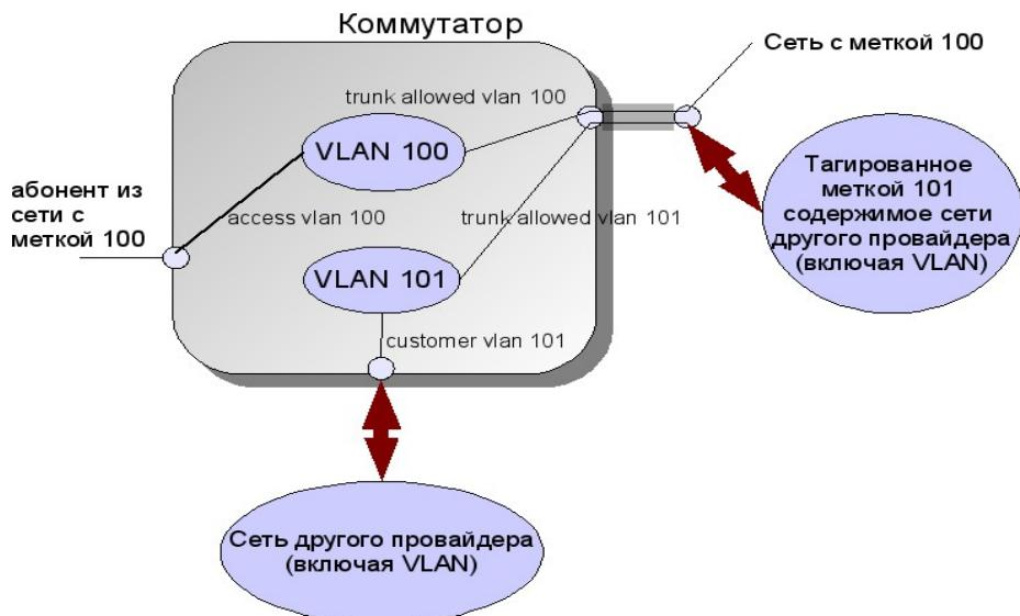
Рисунок 13: Вариант с двойным тегированием (QinQ)
