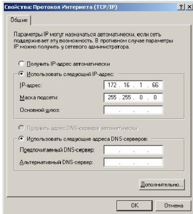
Рисунок 7: Установка IP-адреса для ПК
