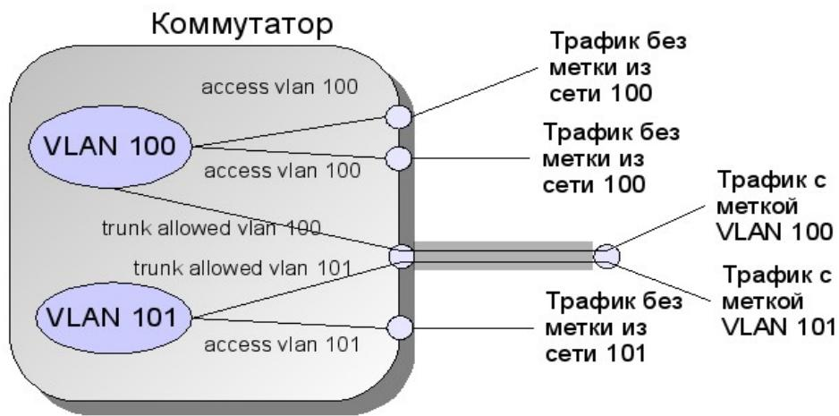
Рисунок 11: Использование одного физического порта (trunk порта) для передачи трафика двух независимых виртуальных сетей.
