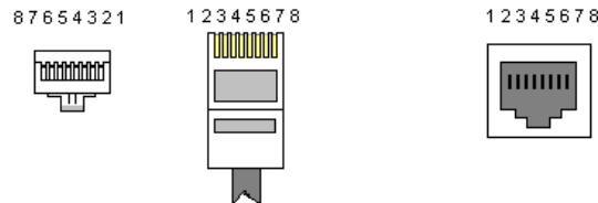
**Рисунок 15: Общий вид разъема и розетки RJ-45**
