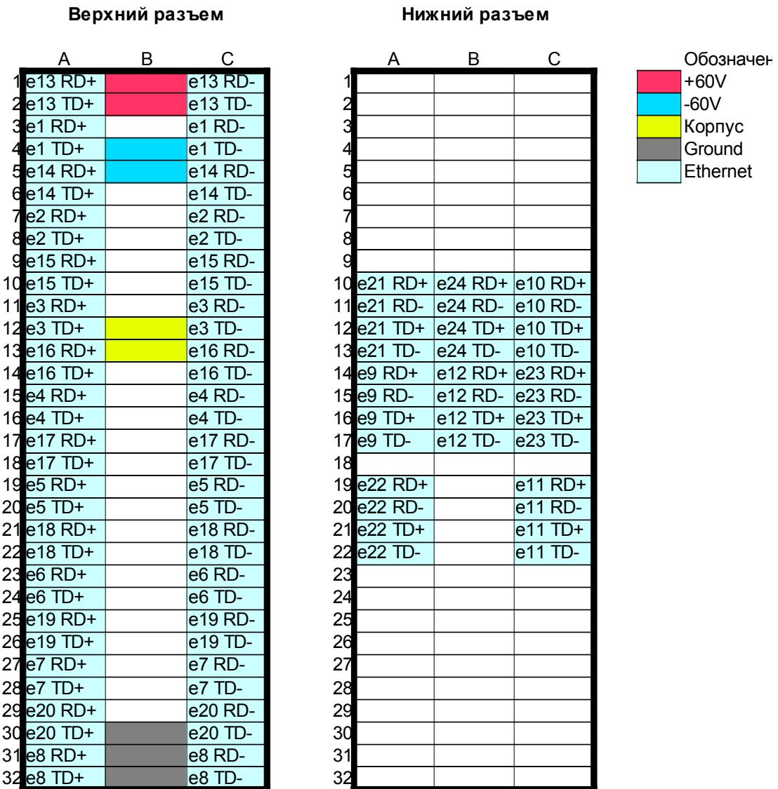
Рисунок 16: Назначение контактов на разъеме
