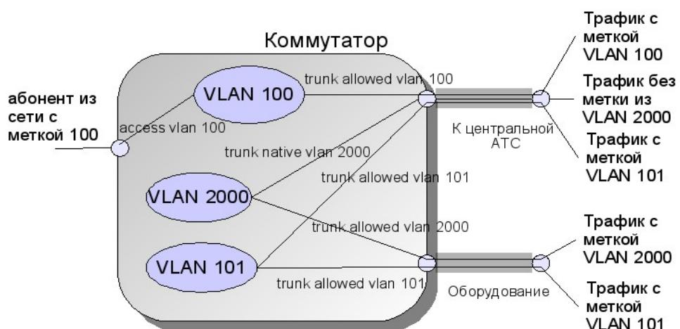
Рисунок 12: Вариант пропускания через trunk порт как тегированных, так и нетегированных пакетов
