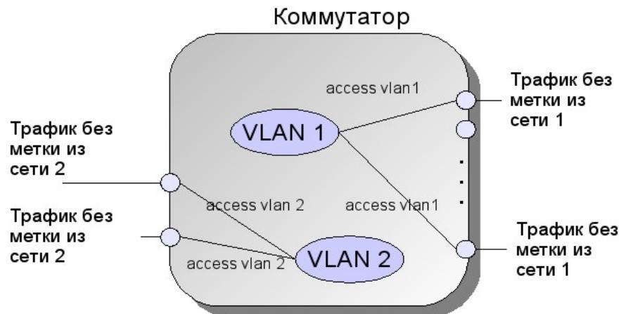
Рисунок 10: Разделение на 2 виртуальные сети при помощи коммутатора
